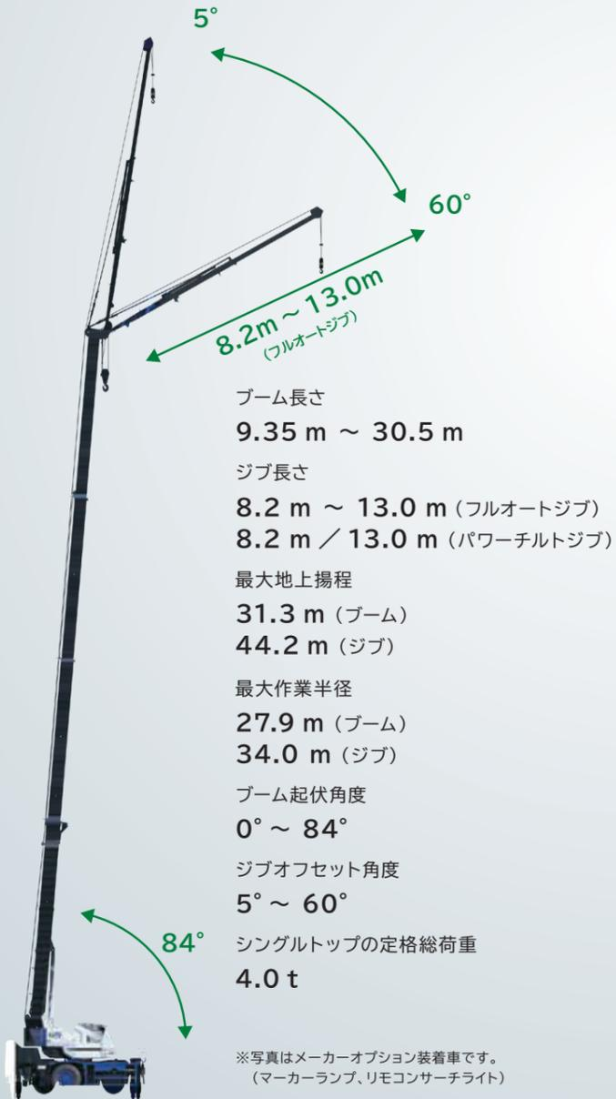
狭所現場でもジブ伸長がスピーディに行えるフルオートジブ。60°のジブチルトの深い懐と84°のメインブーム最大起伏角度により広範囲をサポートします。
