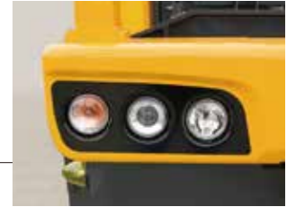
▲丸型プロジェクタータイプヘッドランプ(ディスチャージはオプション)
